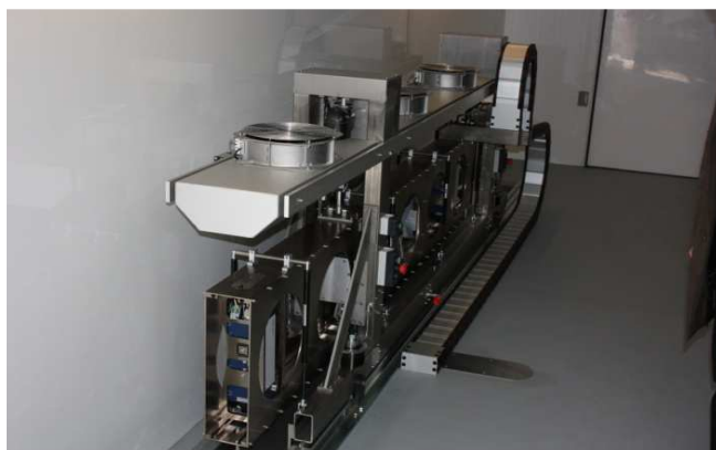
Fot. A.2. Belka z czujnikami pomiarowymi
